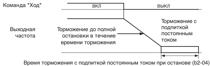
Рис. 6.14 Торможение до полной остановки
