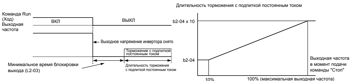
Рис. 6.16 Торможение с подпиткой постоянным током
